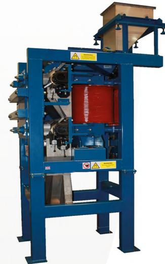
Separatore a Rullo Indotto e pannello di controllo (unità a 2 rulli di larghezza 500 mm)
